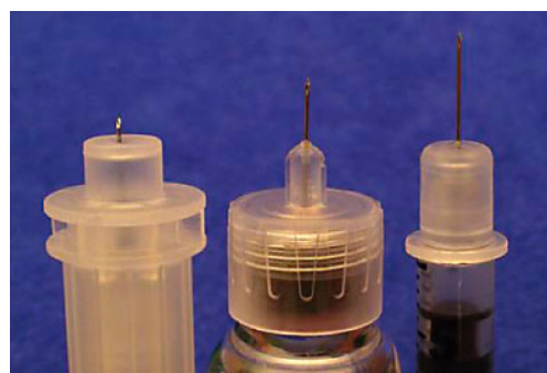
Abbildung Eine 1,5 mm Edelstahl-Mikrokanüle (links) im Vergleich zu einem handelsüblichen Insulin-Pen (5 mm, BD Ultra Fine™ III) (Mitte) und einer handelsüblichen Insulin-Injektionsnadel (8 mm, BD Ultra Fine II) (rechts).
